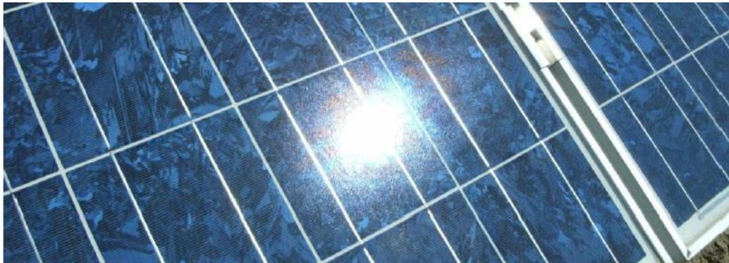
Diffuse Reflexion von direktem Sonnenlicht auf einem PV-Modul
